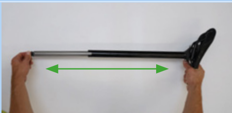
Figura 199: Estrazione completa del tubo del canotto reggisella
