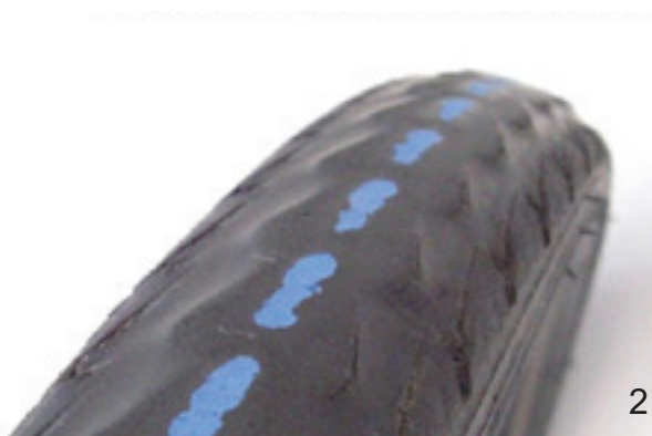
Figura 134: Pneumatico senza profilo ancora utilizzabile (1) e pneumatico con protezione contro le forature in vista (2) che deve essere sostituito
