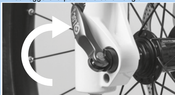
Figura 66: Chiusura del bloccaggio rapido
