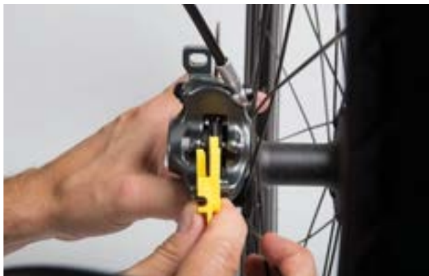
Figura 136: Controllo della guarnizione del freno nello stato montato mediante la sicura di trasporto
