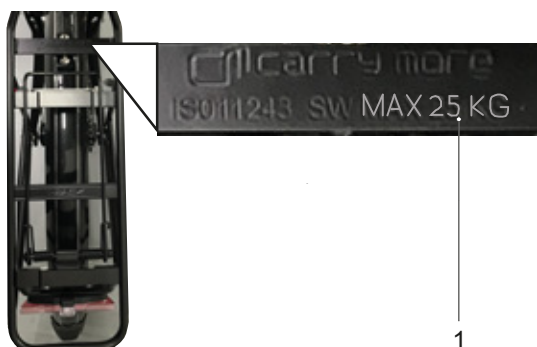
Figura 115: Sul portapacchi è indicata la sua portata massima (1).
