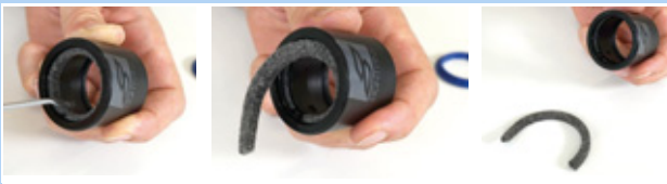
Figura 193: Rimozione dell'anello di feltro
