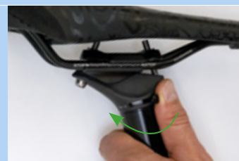
Figura 203: Chiusura della regolazione in altezza
