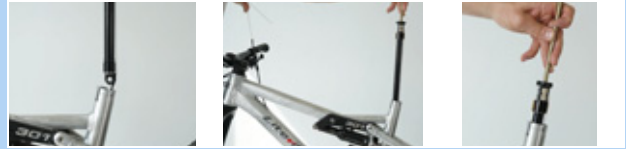
Figura 175: Fissaggio del coperchio della valvola della cartuccia
