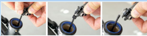
Figura 188: Rimozione del cavo meccanico
