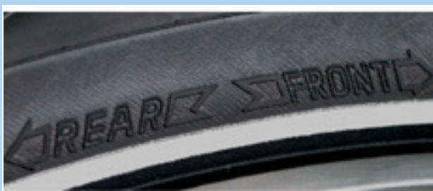
Figura 68: Freccia del senso di rotazione su pneumatici MTB
