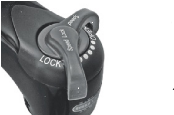
Figura 216: Regolazione più morbida del regolatore dello stadio di compressione
