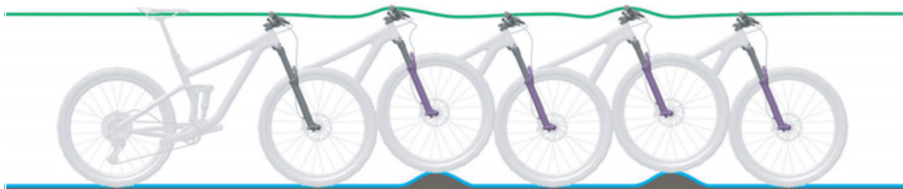
Figura 11: Comportamento di marcia ottimale della forcella
