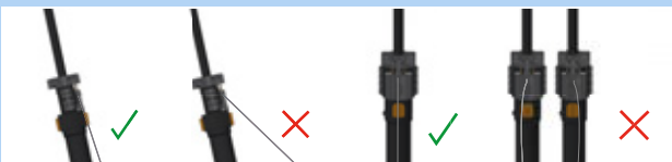
Figura 174: Cavo meccanico corretto ed errato
