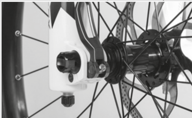
Afbeelding 36: Perfecte stand van de spanhendel
