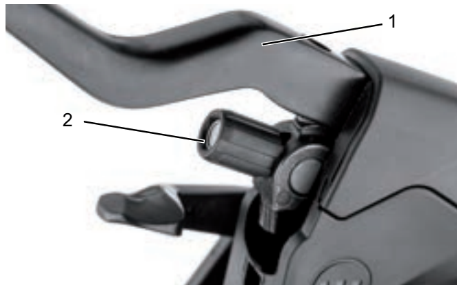
Afbeelding 81: Remhendel (1) van de hydraulisch bediende velgrem met afstelschroef (2)
