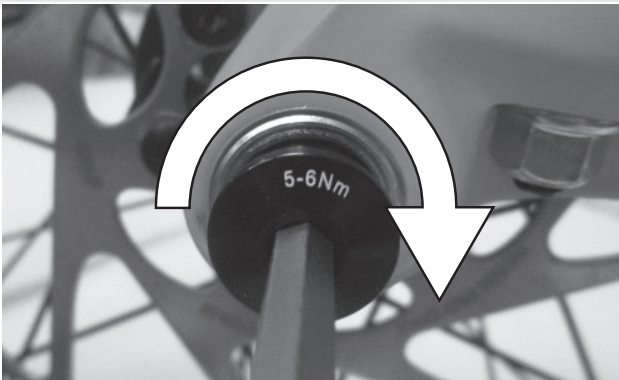
Abbildung 29: Sicherungsschraube anziehen
