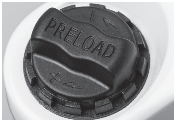
Abbildung 59: Einstellrad des Negativen Federwegs auf der Krone der Federgabel
