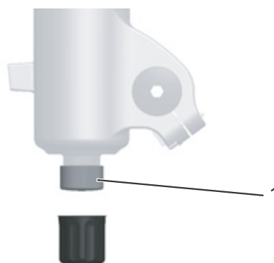
Afbeelding 48: FOX trekdemperafsteller (1) op het uitvaleinde van de vork
