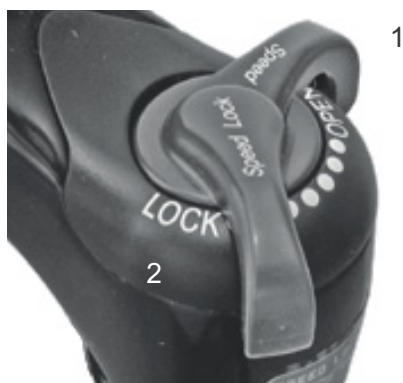
Afbeelding 55: Suntour drukdemperafsteller met de standen OPEN (1) en LOCK (2)
