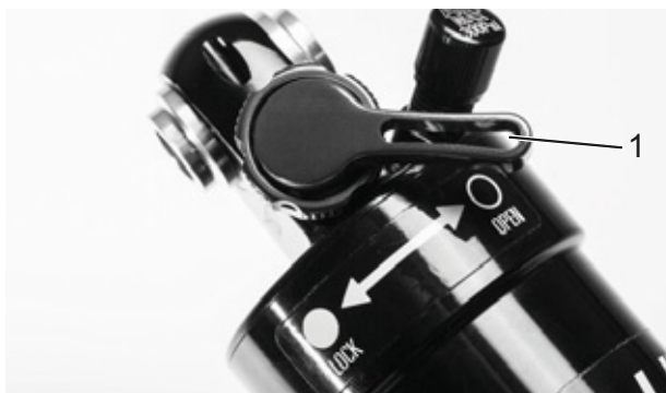
Afbeelding 56: Suntour drukdemperafsteller geopend (1)
