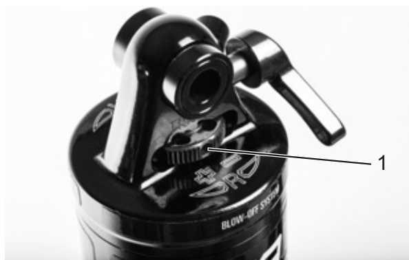
Afbeelding 49: Wiel (1) van de Suntour trekdemperafsteller op de achterbouwdemper
