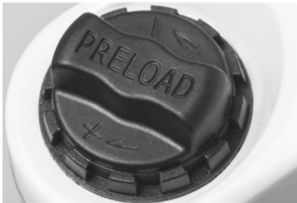
Afbeelding 45: Afstelwiel voor de negatieve veerweg op de kroon van de verende voorvork
