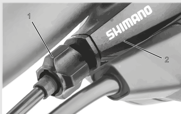
Rysunek 88: Nakrętka regulacyjna (1) jednocięgowego mechanizmu zmiany przerutek z obudową dźwigni zmiany biegów (2), przykład
