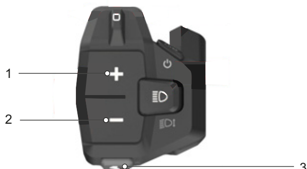
Obr. 118: Poloha tlačítka Plus (1), Minus (2), a Funkce podpory - tlačení (3)
