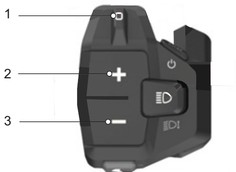
Obr. 105: Poloha přepínacího tlačítka Navigace (1), tlačítka Plus (2) a Minus (3)
