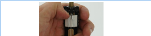
Obr. 171: Posunutí bílého ovládacího šoupátka dolů
