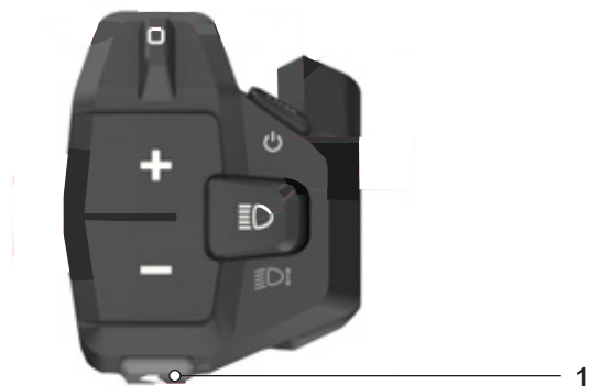
Obr. 116: Poloha tlačítka funkce podpory tlačení
