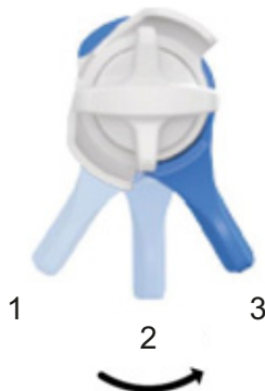
Obr. 97: Nastavení trojcestné páky z polohy zavřeno (1) přes střední polohu (2) do polohy otevřeno (3)
