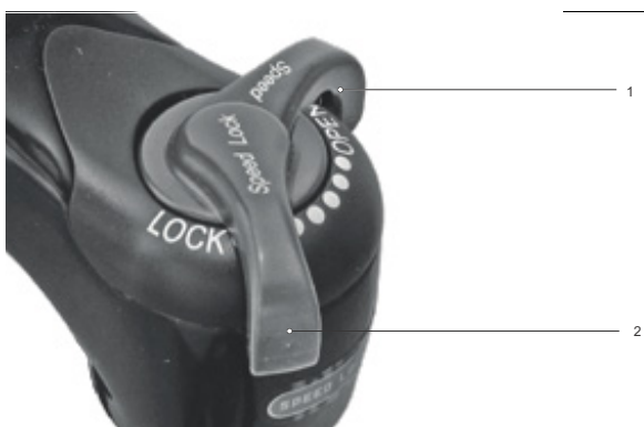
Obr. 214: Měkké nastavení nastavovacího šroubu komprese
