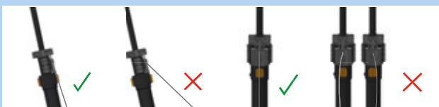
Obr. 172: Správné a nesprávné vedení bovdenů
