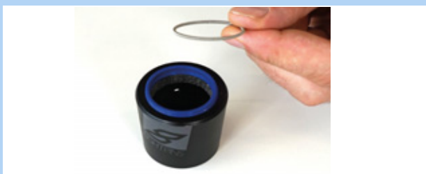
Obr. 189: Vyjmutí pružné podložky
