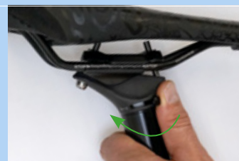
Obr. 201: Zavření nastavení výšky
