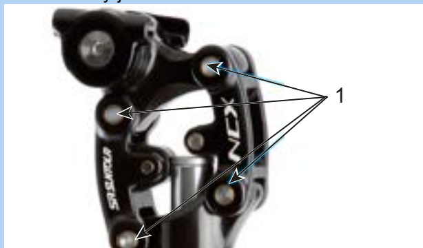
Obr. 144: Mazací body odpružené sedlovky Suntour SR
