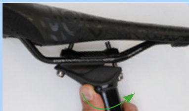
Obr. 196: Otevření nastavení výšky
