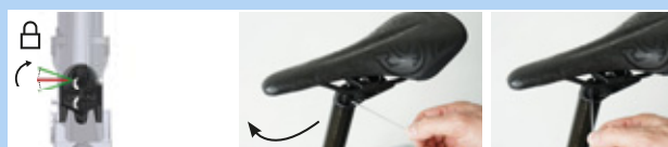
Obr. 182: Zavření nastavení výšky
