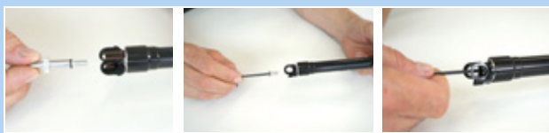
Obr. 164: Upevnění krytu ventilku kazety
