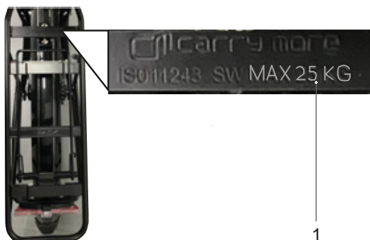
Obr. 112: Na nosiči zavazadel je uvedena jeho maximální nosnost (1)
