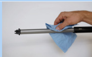
Obr. 198: Očištění podélné vodicí drážky
