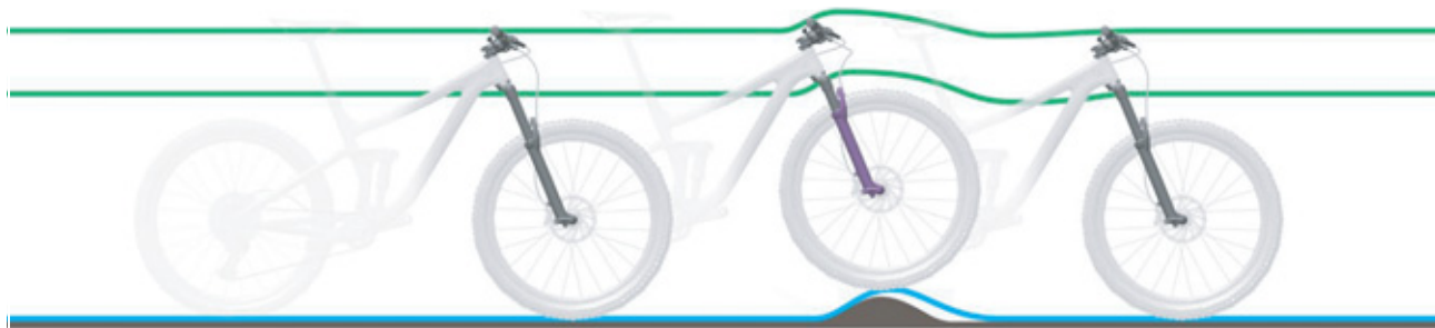
Obr. 222: Příliš tvrdé tlumení odpružené vidlice u nerovnosti
