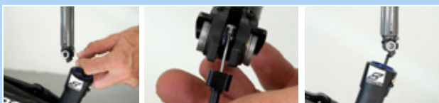
Obr. 203: Zavedení a zasunutí sedlovky
