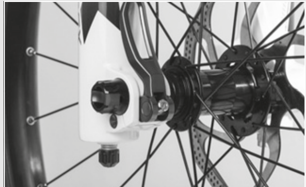
Afbeelding 30: Perfecte stand van de spanhendel
