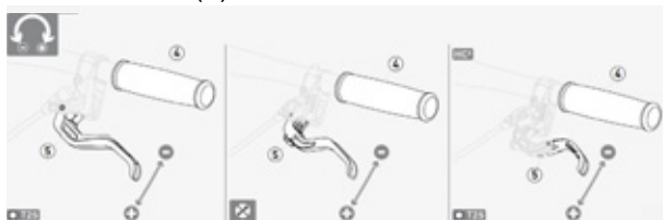
Afbeelding 50: Grijpafstand remhendel Magura schijfrem afstellen
