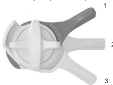
Afbeelding 65: FOX-drukdemperafsteller op de achterbouwdeemper met de standen OPEN (1), MIDDEL (2) en HARD (3)
