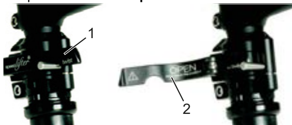
Afbeelding 46: Gesloten (1) en geopende (2) voorbouwspanhendel, voorbeeld by.schulz speedlifter
