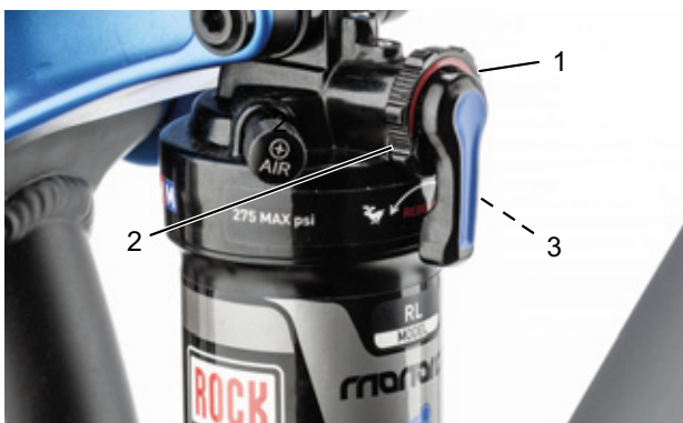
Afbeelding 70: Hardheid van de trekdemper afstellen met het afstelwiel (1) van de achterbouwdemper
