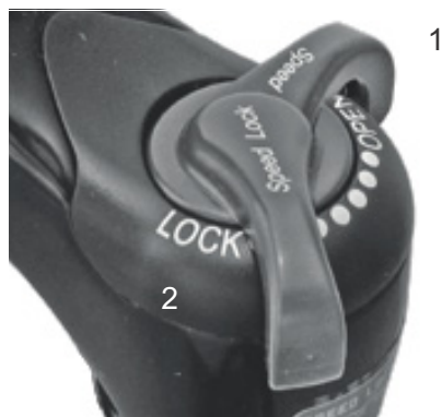
Afbeelding 67: Suntour-drukdemperafsteller met de standen OPEN (1) en LOCK (2)
