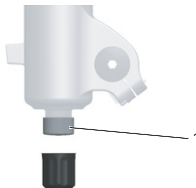
Afbeelding 55: FOX trekdemperafsteller (1) op het uitvaleinde van de vork
