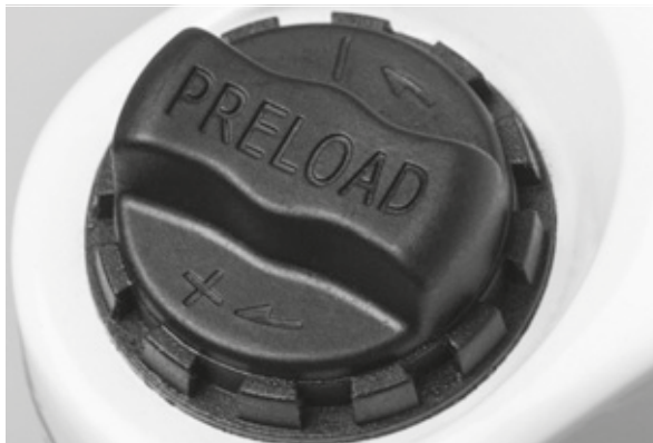
Afbeelding 52: Afstelwiel voor de negatieve veerweg op de kroon van de verende voorvork
