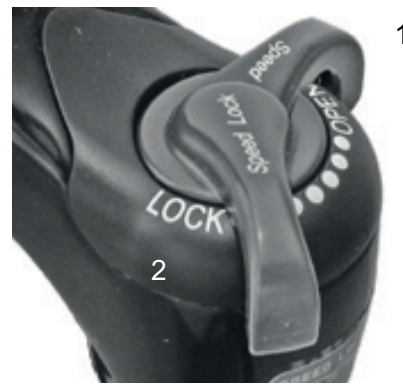
Abbildung 80: Suntour-Druckstufeneinsteller mit den Positionen OPEN (1) und LOCK (2)
