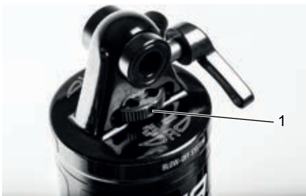
Abbildung 61: Suntour-Zugstufeneinsteller Rad (1) am Hinterbau-Dämpfer
