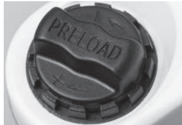
Abbildung 57: Einstellrad des Negativfederwegs auf der Krone der Federgabel
