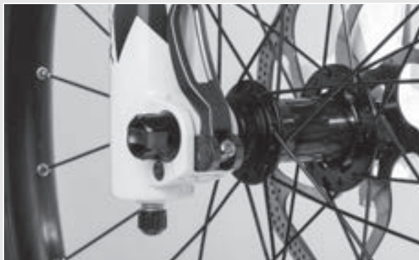
Abbildung 88: Spannkraft des Schnellspanners einstellen
