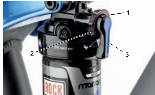
Abbildung 83: Härte des Zugstufen-Dämpfers am Einstellrad (1) des Hinterbau-Dämpfer einstellen
