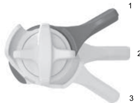
Abbildung 78: FOX-Druckstufeneinsteller am Hinterbau-Dämpfer mit den Positionen OFFEN (1), MITTEL (2) und HART (3)
