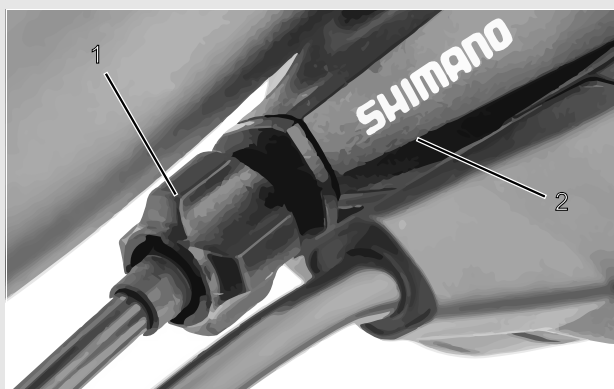
Abbildung 90: Einstellhülse (1) der einzügigen, seilzugbetätigten Gangschaltung mit Schalthebelgehäuse (2), Beispiel
