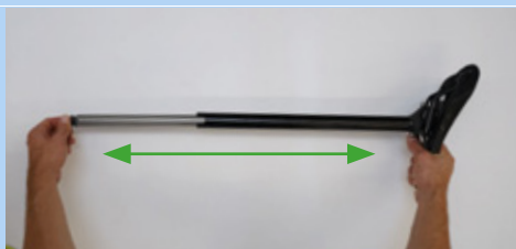
Figura 217: Estrazione completa del tubo del canotto reggisella
