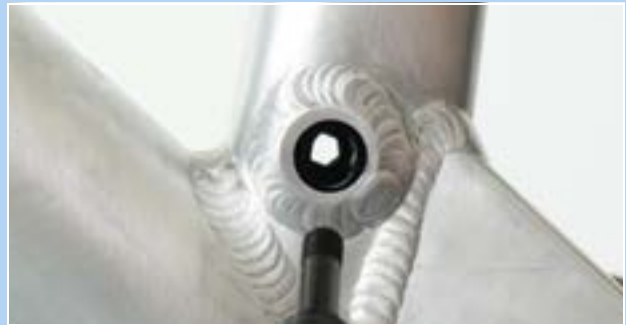
Figura 225: Foro dell'interfaccia Postpin
