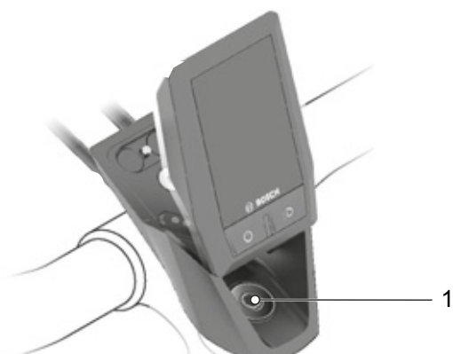
Figura 125: Ubicazione della vite della serie sterzo
