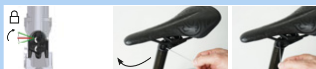
Figura 202: Chiusura della regolazione in altezza
