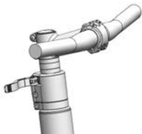
Figura 145: Esempio: All Up con leva di serraggio dell'attacco manubrio aperta
