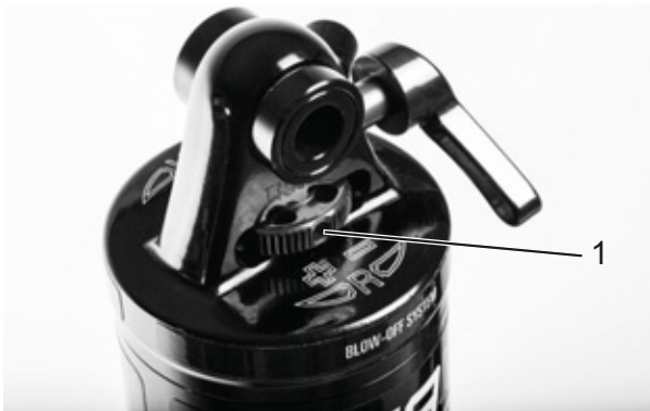
Figura 236: Regolatore del rebound Suntour (1) sull'ammortizzatore del carro posteriore
