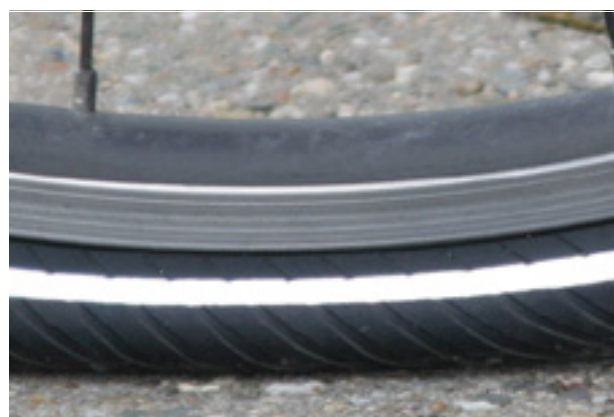
Figura 103: Pressione di gonfiaggio insufficiente
