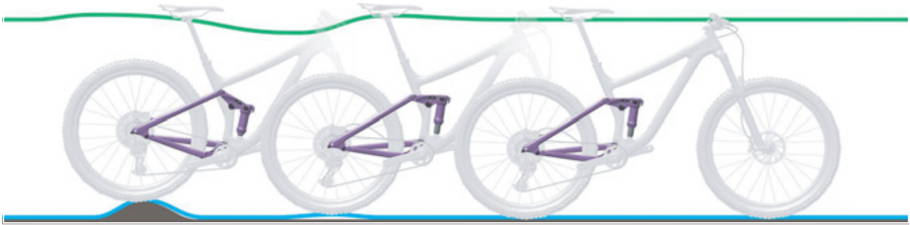
Figura 235: Corsa di estensione troppo veloce dell'ammortizzatore del carro posteriore
