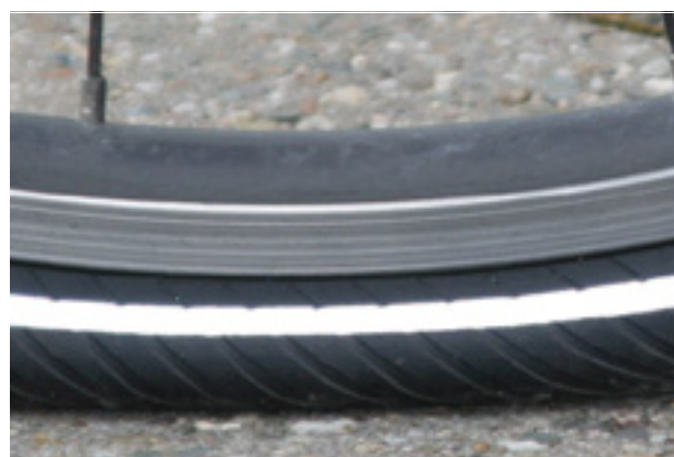
Figura 109: Pressione di gonfiaggio insufficiente
