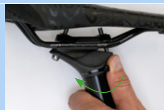
Figura 221: Chiusura della regolazione in altezza
