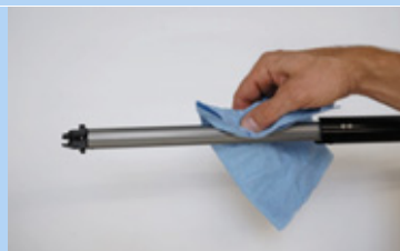
Figura 218: Pulizia della scanalatura di guida longitudinale
