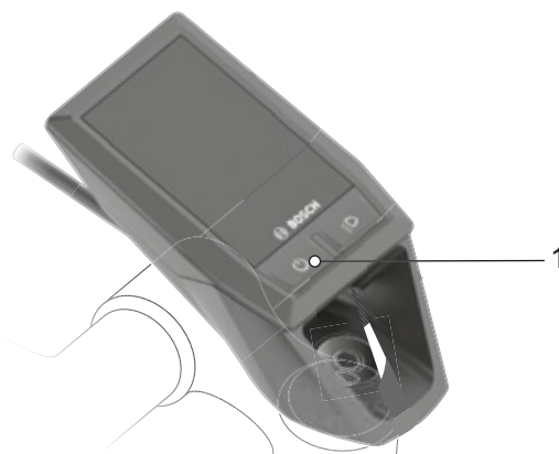
Figura 138: Ubicazione del pulsante On/Off (terminale di comando)
