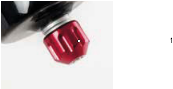
Figura 228: Vite del rebound Suntour (1)
