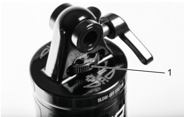
Figura 238: Regolatore del rebound Suntour (1) sull'ammortizzatore del carro posteriore
