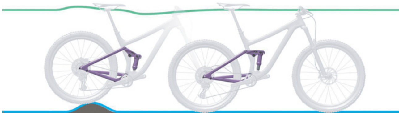
Figura 117: Comportamento di marcia ottimale dell'ammortizzatore del carro posteriore su asperità
