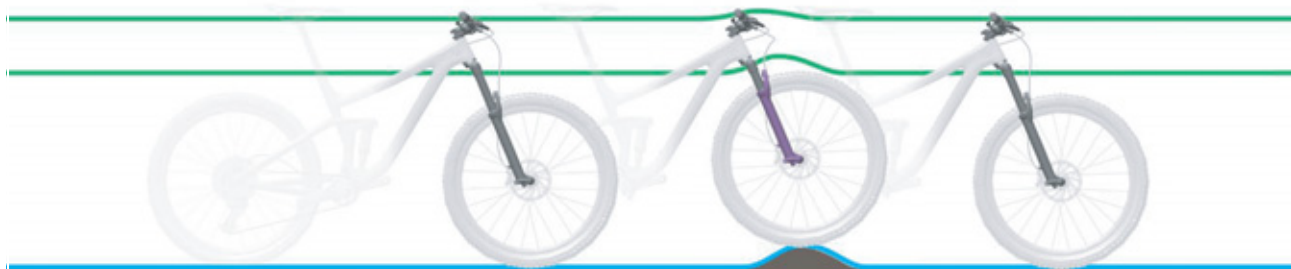
Figura 10: Comportamento di marcia ottimale della forcella su un terreno con asperità
