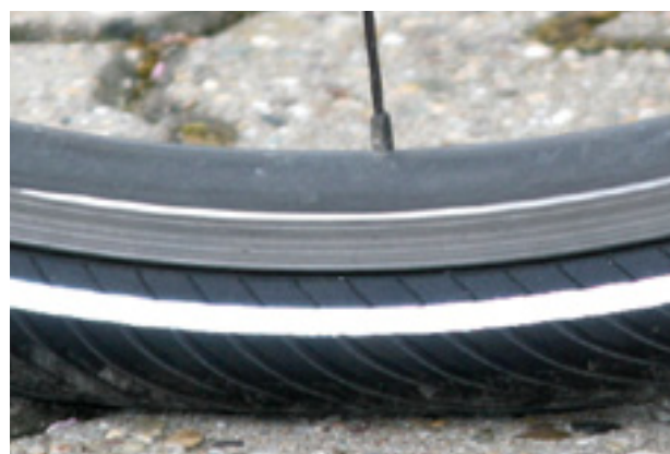
Figura 108: Corretta pressione di gonfiaggio. Lo pneumatico quasi non si deforma sotto il peso corporeo
