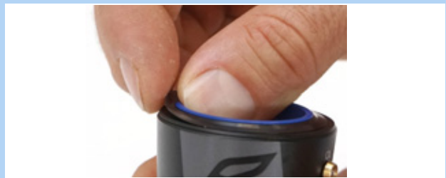
Figura 208: Estrazione dell'anello a labbro di tenuta
