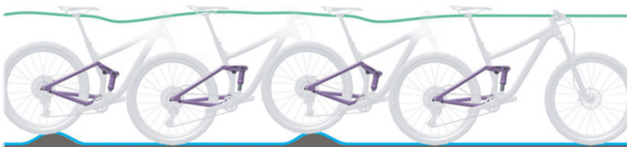
Figura 115: Comportamento di marcia ottimale dell'ammortizzatore del carro posteriore
