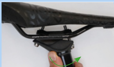
Figura 216: Apertura della regolazione in altezza
