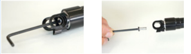
Figura 185: Svitamento del cappuccio della valvola
