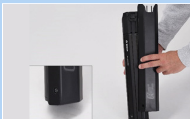
Figura 64: Applicazione della copertura della batteria sulla batteria
