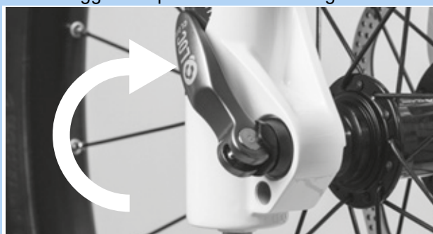
Figura 80: Chiusura del bloccaggio rapido
