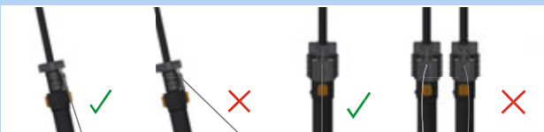
Figura 192: Cavo meccanico corretto ed errato
