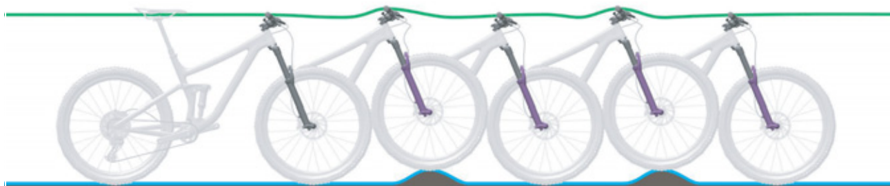
Figura 113: Comportamento di marcia ottimale della forcella
