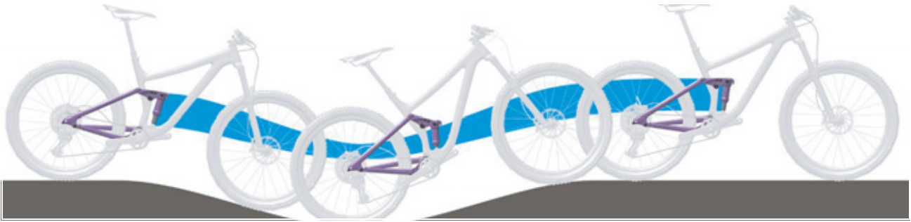
Figura 239: Sospensione dell'ammortizzatore del carro posteriore troppo morbida in salita
