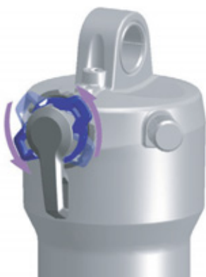
Afbeelding 66: Drukdemperafsteller zachter afstellen
