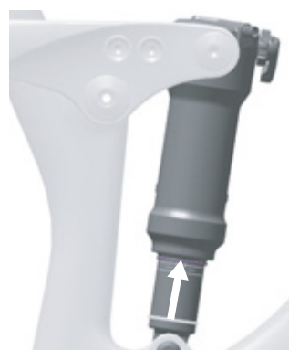
Afbeelding 57: O-ring op de achterbouwdemper verschuiven
