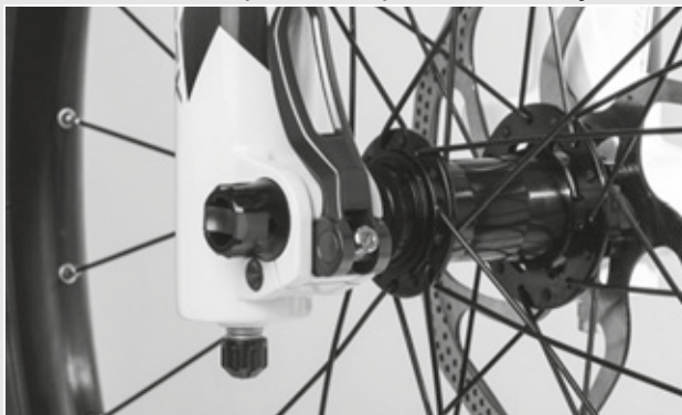
Afbeelding 94: Spankracht van de snelspanner afstellen
