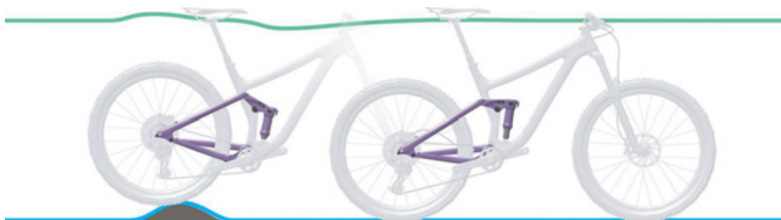
Afbeelding 12: Optimaal rijgedrag van de achterbouwdeemper bij oneffenheden
