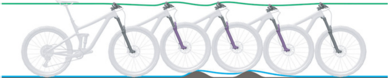
Afbeelding 101: Te langzaam uitveren van de verende voorvork
