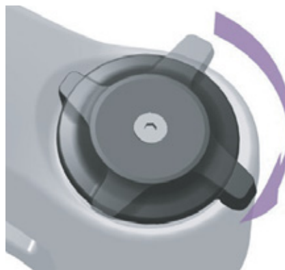
Afbeelding 89: Drukdemperafsteller harder afstellen
