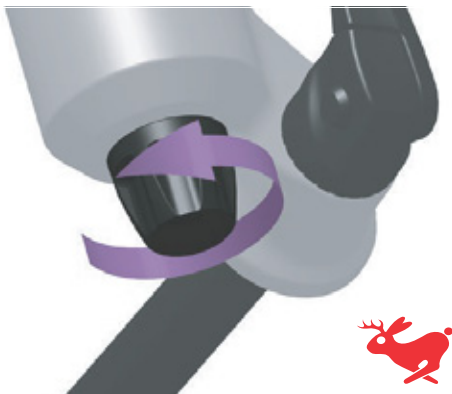
Afbeelding 102: Draai de trekdemperafsteller in de richting van de haas
