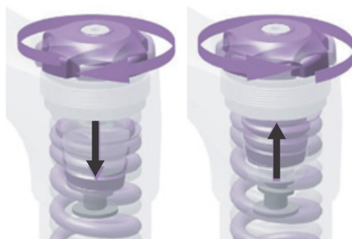
Afbeelding 52: Voorspanningsafstelling in- en uitdraaien
