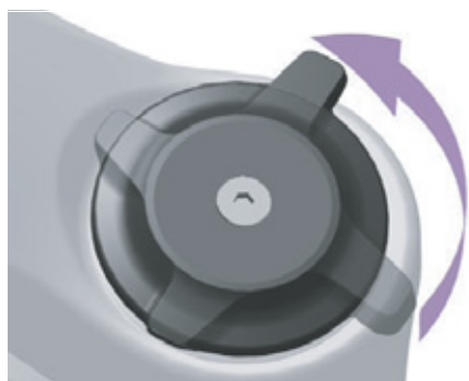
Afbeelding 90: Drukdemperafsteller zachter afstellen
