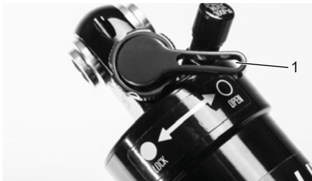
Illustration 79 : Dispositif de réglage de la compression Suntour ouvert (1)
