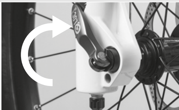
Illustration 41 : Fermer l'attache rapide
