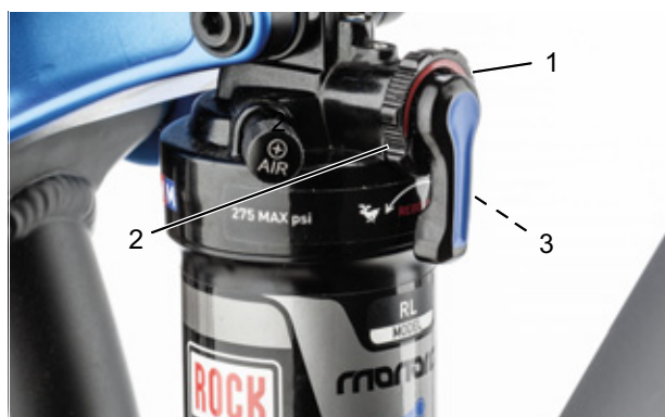
Illustration 81 : Régler la dureté de l'amortisseur de détente (1) de l'amortisseur arrière
