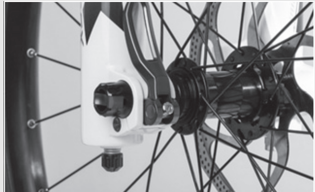
Afbeelding 38: Perfecte stand van de spanhendel
