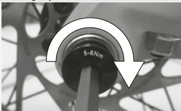
Rysunek 31: Sposób dokręcania śruby zabezpieczającej
