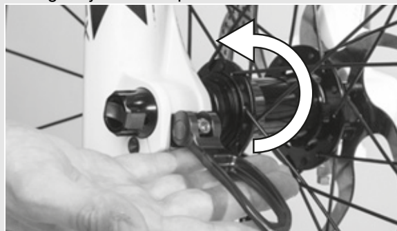
Rysunek 37: Sposób zabezpieczenia dźwigni
