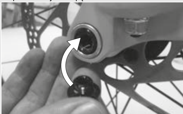
Rysunek 30: Sposób wsuwania dźwigni zacisku szybkoocucjącego w oś
