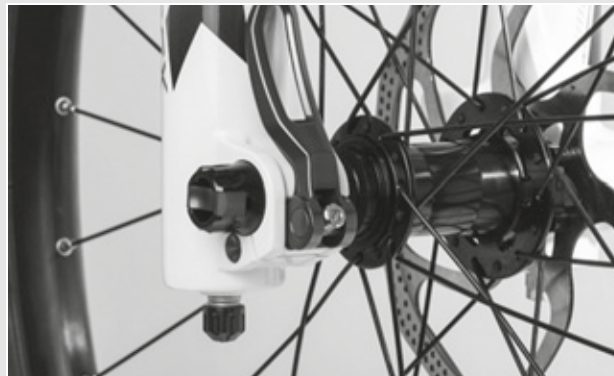
Rysunek 87: Ustawianie siły mocowania zacisku szybko mocującego
