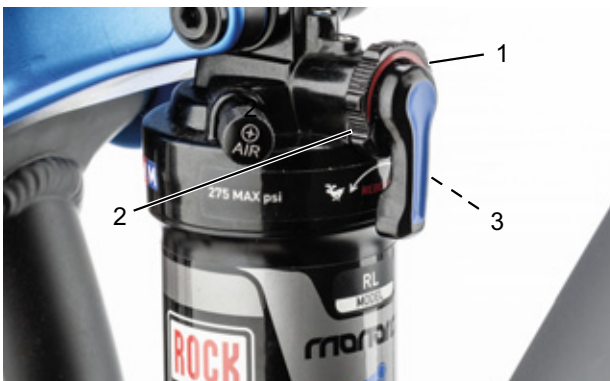
Rysunek 82: Ustawianie twardości tłumika odbicia za pomocą pokrętła regulacyjnego (1)
