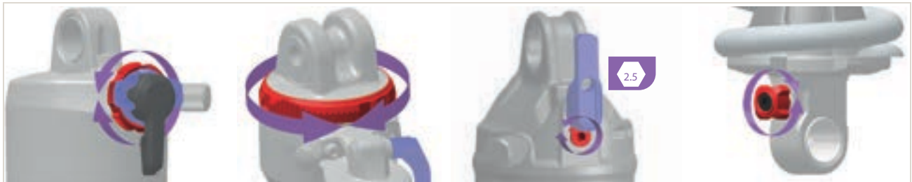
Abbildung 326: Lage und Form des Zugstufen-Einstellers (rot) ist Modellabhängig
