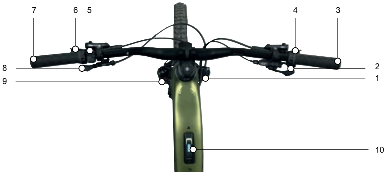
Abbildung 60: Detailansicht Lenker mit Bordcomputer BOSCH System Controller und Bedieneinheit Mini Remote, Beispiel
