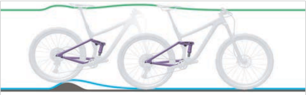
Abbildung 337: Zu harte Dämpfung des Hinterbau-Dämpfers bei Unebenheiten
