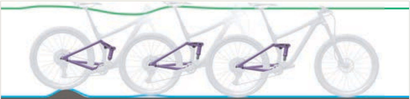
Abbildung 323: Zu schnelles Ausfedern des Hinterbau-Dämpfers
