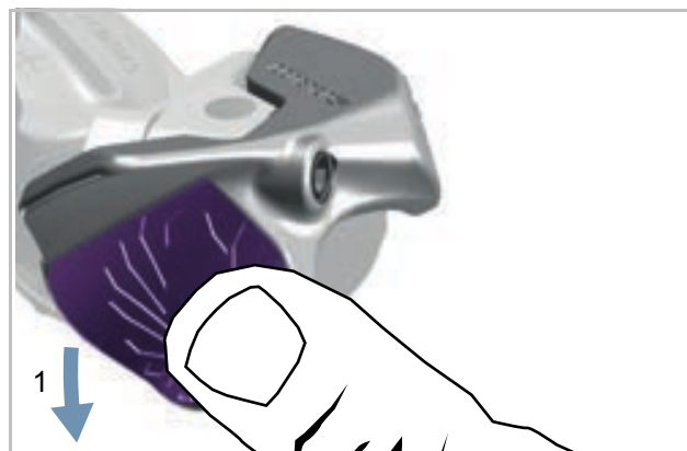
Abbildung 160: Schaltwippe nach unten drücken
