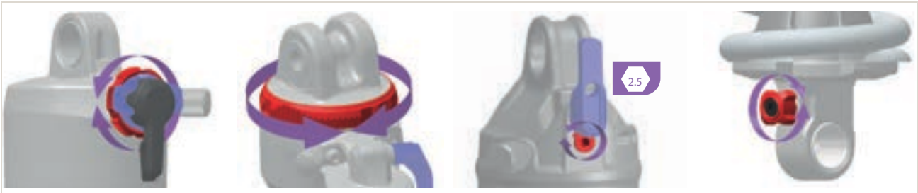
Abbildung 176: Lage und Form des Zugstufen-Einstellers (Hinterbau-Dämpfer) ist abhängig vom Modell. Zugstufen-Einsteller sind immer rot.
