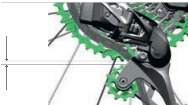
Abbildung 159: 3 mm Abstand zwischen Umlenkrolle und Zähnen
