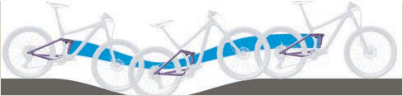
Abbildung 335: Zu weiche Federung des Hinterbau-Dämpfers am Berg
