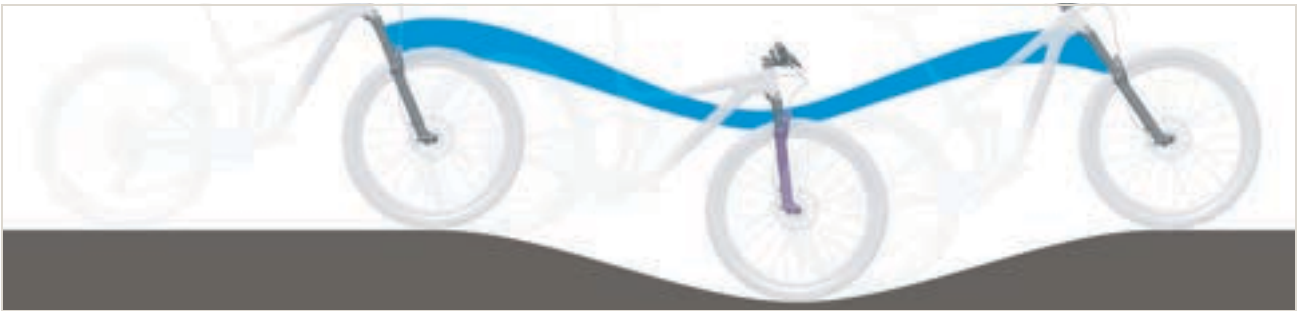
Abbildung 313: Zu weiche Federung der Federgabel am Berg
