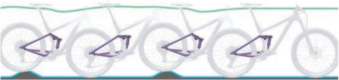
Abbildung 8: Optimales Fahrverhalten des Hinterbau-Dämpfers
