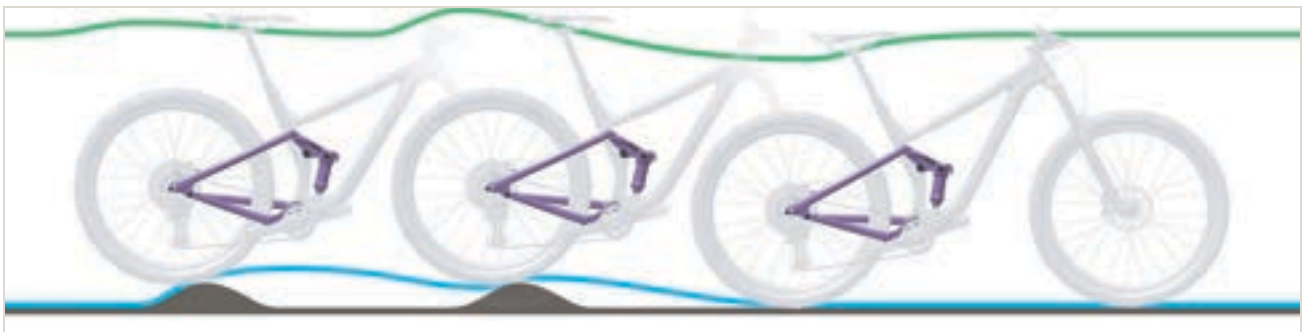
Abbildung 325: Zu langsames Ausfedern des Hinterbau-Dämpfers
