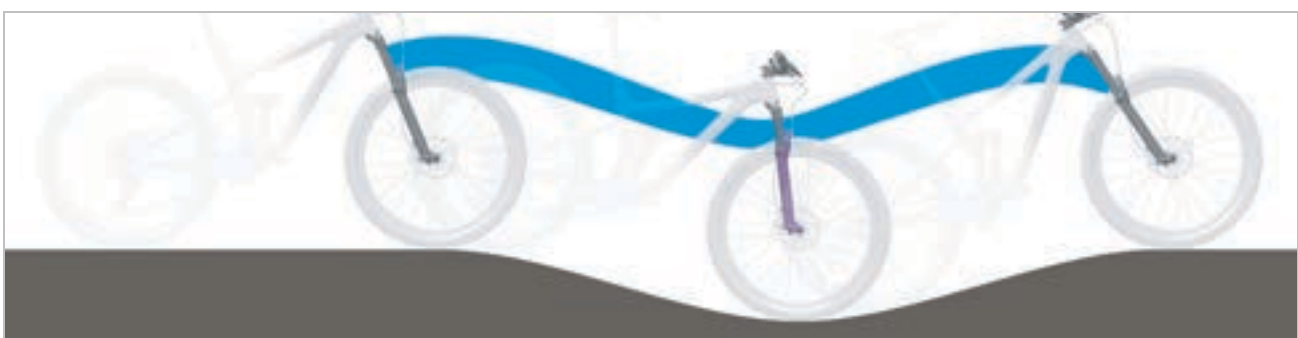
Abbildung 22: Optimales Fahrverhalten der Federgabel im hügeligen Gelände
