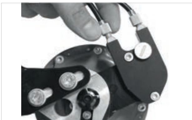
Abbildung 240: ROHLOFF-Naben Versionen mit externer Schaltersteuerung haben die Zugeinsteller an der Seilbox, die sich auf der linken Seite befindet
