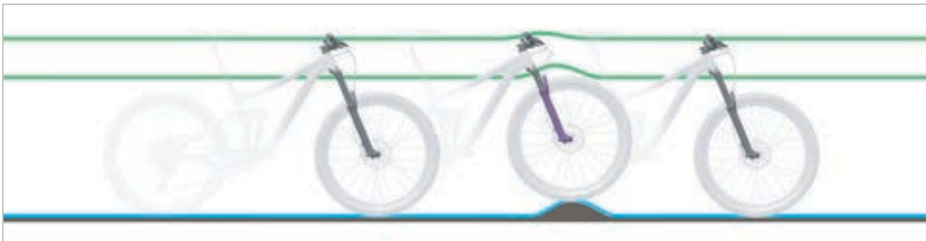
Abbildung 204: Hart und weich eingestellter Druckstufen-Dämpfer
