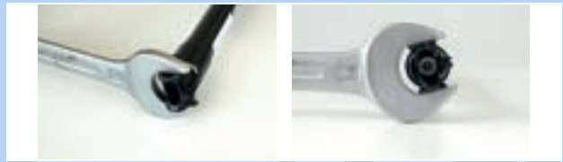
Abbildung 267: Gegen Verdrehen sichern
