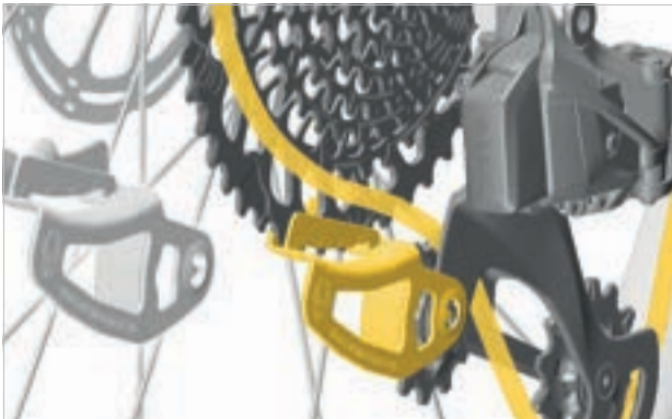
Abbildung 153: Kette liegt auf dem zweitgrößten Zahnkranz.
