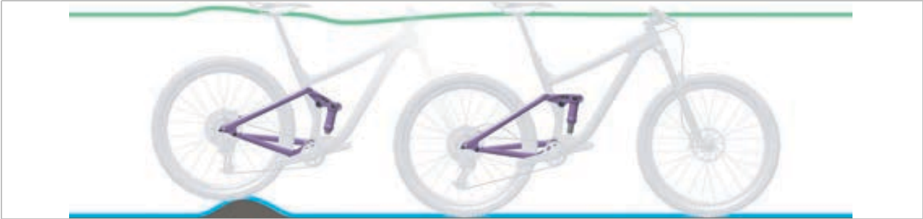
Abbildung 7: Optimales Fahrverhalten des Hinterbau-Dämpfers bei Unebenheiten
