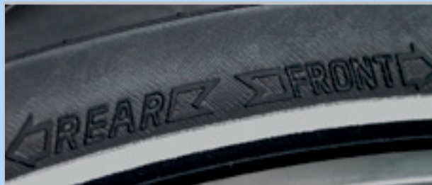
Abbildung 87: Laufrichtungspfeil auf MTB-Reifen
