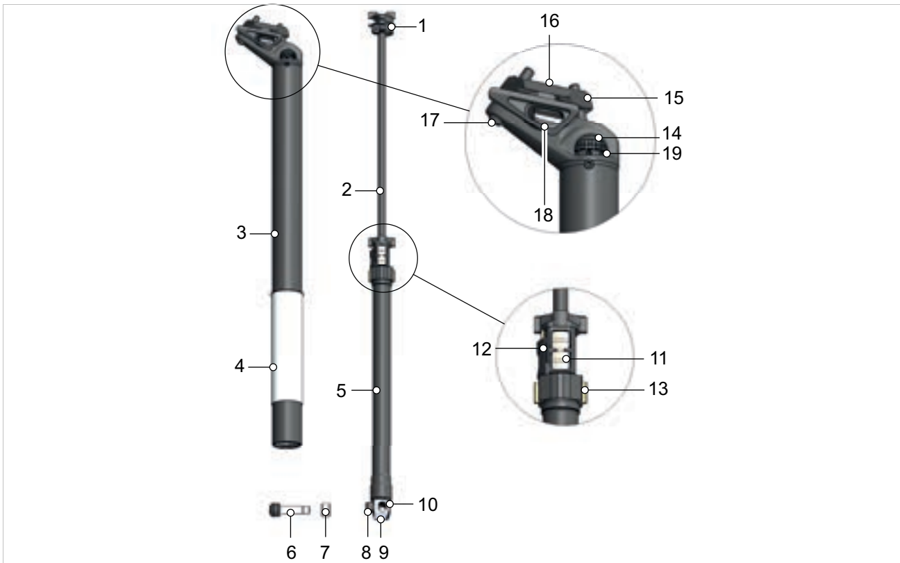
Abbildung 45: Aufbau 8Pins Sattelstütze
