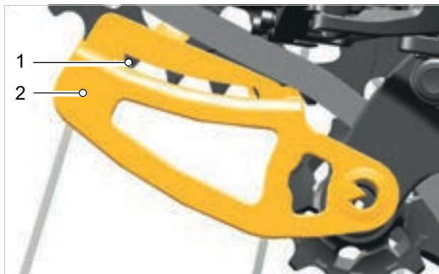
Abbildung 154: Fensterausschnitt (1) mit Zähnen in der Chain Gap-Messlehre (2)
