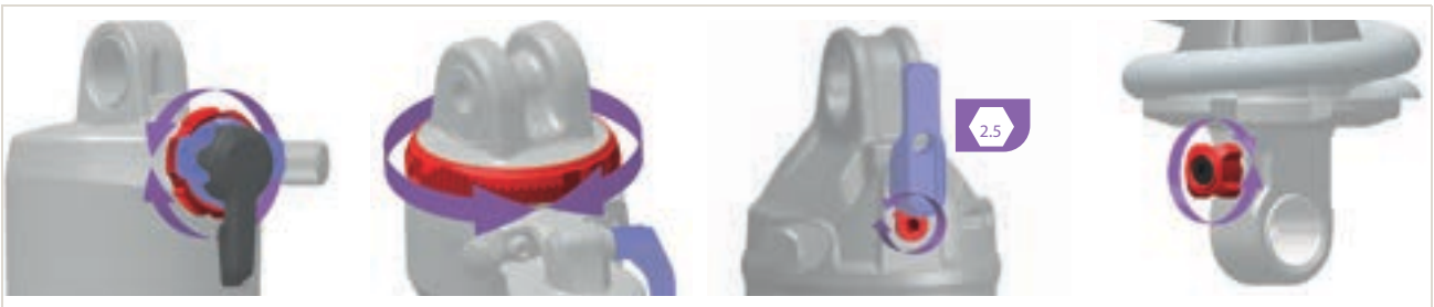
Abbildung 324: Lage und Form des Zugstufen-Einstellers (Hinterbau-Dämpfer) (rot) ist Modellabhängig
