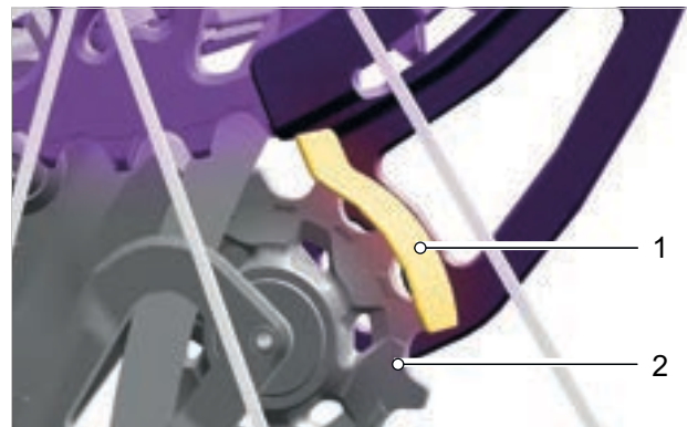
Abbildung 155: Die Finne (1) berührt die obere Umlenkrolle (2)
