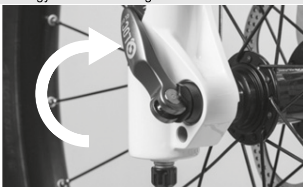
54. ábra: A gyorszár zárása
