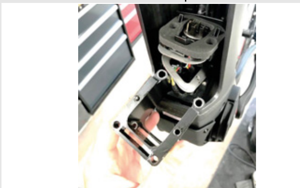
29. ábra: A PowerTube adapter kihúzása
