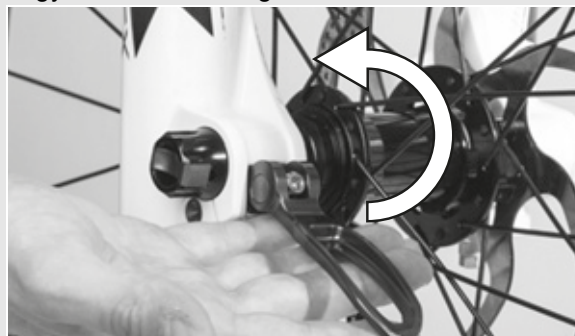
48. ábra: A kar rögzítése
