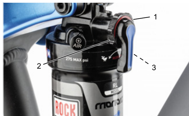
88. ábra: A húzófokozatos lengéscsillapító keménységének beállítása a hátsó lengéscsillapító beállító kerekével (1)
