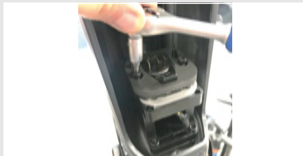
26. ábra: Akkumulátortartó csavarok oldása
