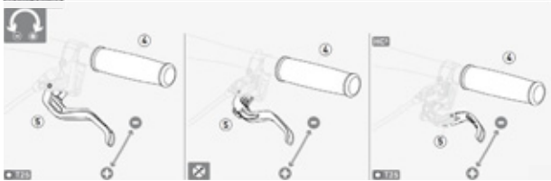
68. ábra: Magura tárcsafék fékkar markolási szélességének beállítása
