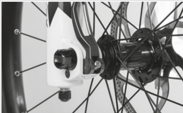
49. ábra: A gyorskioldó kar tökéletes helyzete
