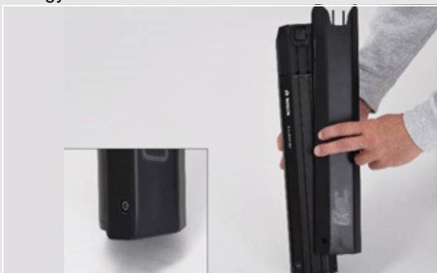
38. ábra: Az akkumulátorfedél rátolása az akkumulátorra
