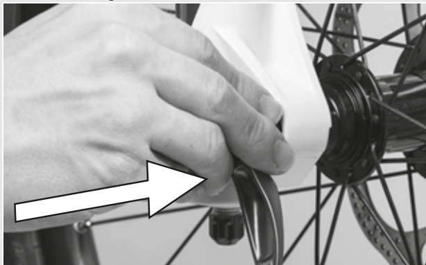
52. ábra: A gyorszár betolása
