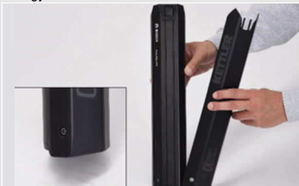
34. ábra: Az akkumulátorfedél rátolása az akkumulátorra
