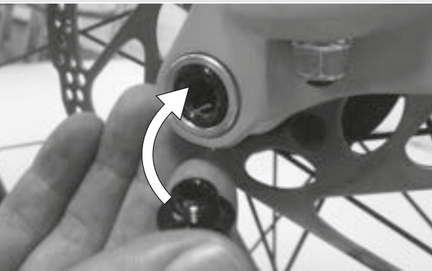
41. ábra: A gyorskioldó kar betolása a tengelybe
