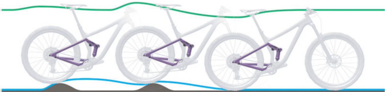
Afbeelding 235: Te langzaam uitveren van de achterbouwdemper
