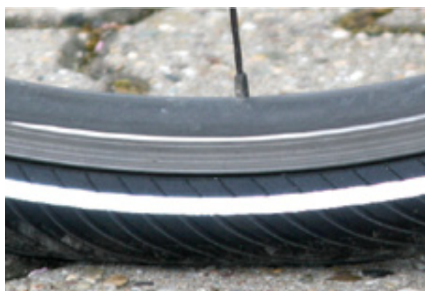
Afbeelding 102: Juiste vuldruk. De band is onder de belasting van het lichaamsgewicht nauwelijks vervormd
