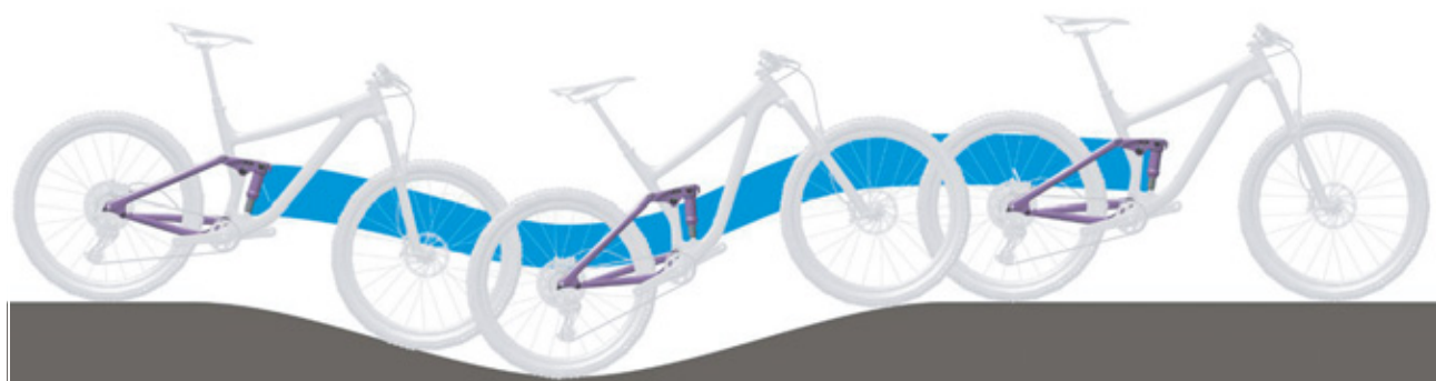
Afbeelding 16: Optimaal rijgedrag van de achterbouwdemper in heuvelachtig terrein
