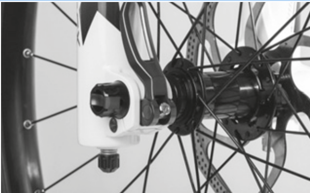
Afbeelding 75: Perfecte stand van de spanhendel
