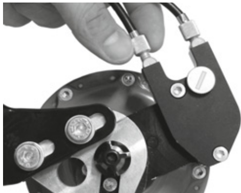
Afbeelding 156: Bij Rohloff naafversies met externe schakelaansturing zit de kabelafsteller op de kabelbox aan de linkerkant.
