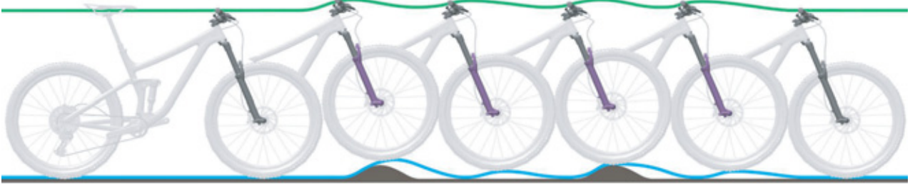
Afbeelding 225: Te snel uitveren van de verende voorvork
