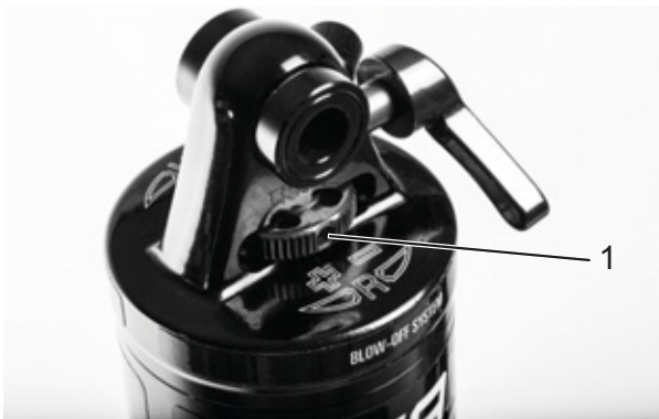
Afbeelding 236: Wiel (1) van de Suntour trekdemperafsteller op de achterbouwdemper
