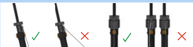
Afbeelding 190: Correcte en verkeerde bowdenkabel
