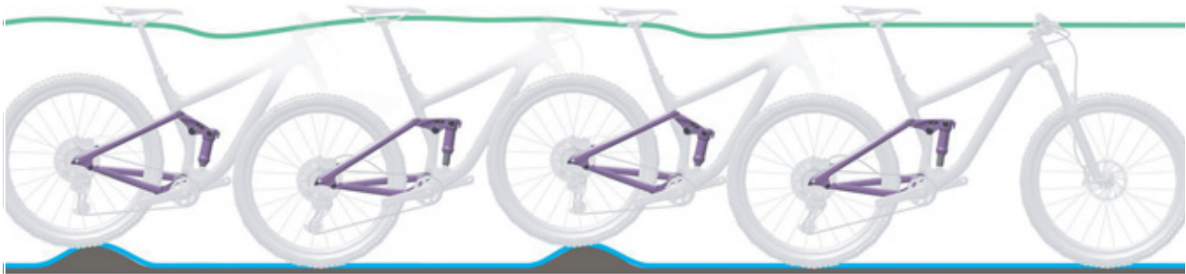
Afbeelding 19: Optimaal rijgedrag van de achterbouwdemper
