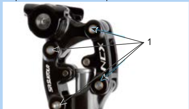
Illustration 146 : Points de lubrification de la tige de selle suspendue SR Suntour
