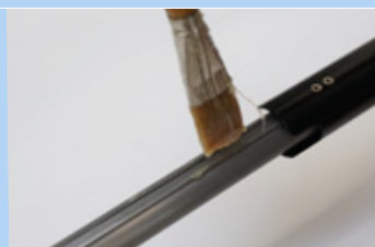
Illustration 201 : Appliquer de la graisse
