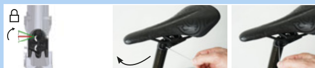
Illustration 184 : Fermer le réglage de la hauteur
