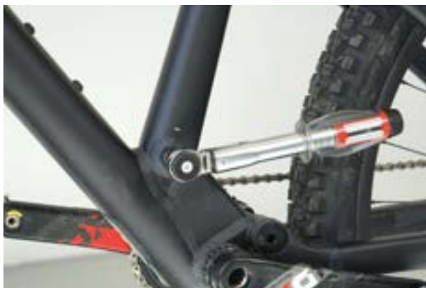
Illustration 75 : Serrer l'axe de la tige de selle
