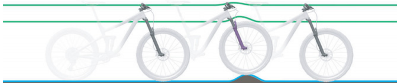
Illustration 123 : Comportement optimal sur les irrégularités
