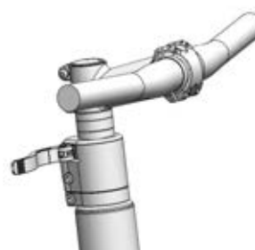
Illustration 127 : All Up avec levier de serrage de la potence ouvert
