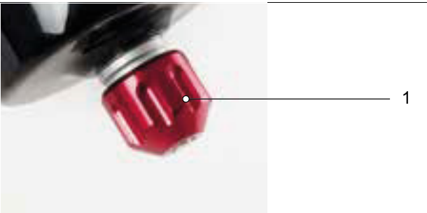
Illustration 212 : Vis de détente Suntour (1)
