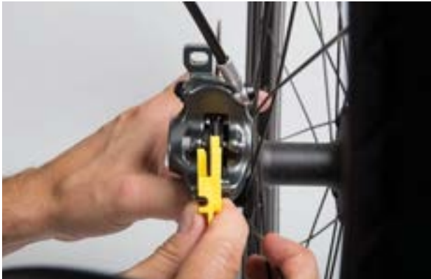
Illustration 136 : Contrôler la plaquette de frein montée à l'aide de la cale de transport
