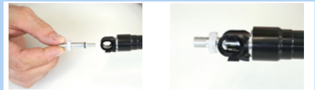
Illustration 164 : Visser l'adaptateur de valve
