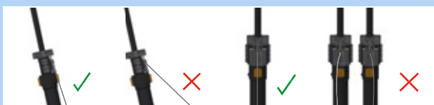
Illustration 174 : Câble Bowden correct et incorrect
