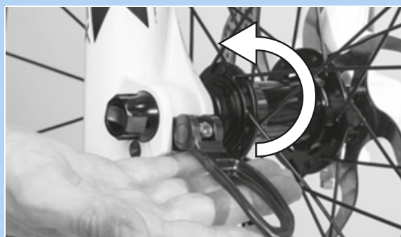
Illustration 60 : Enfoncez le levier d'attache rapide dans le sens de la flèche
